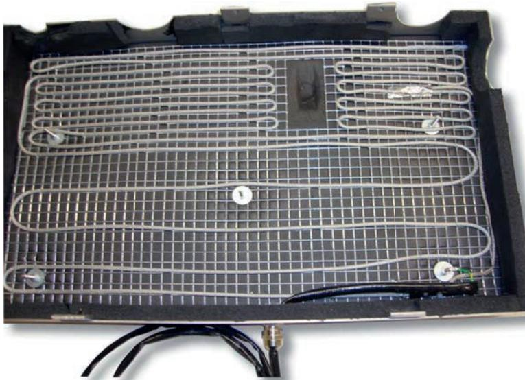
HMG-Gittermatte eingebaut in ein Gehäuse zur Erwärmung eines Verteilers mit einer geometrischen schwierigen Oberfläche.
